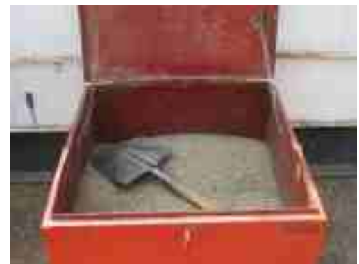
รูปที่ 2-11 ชุดอุปกรณ์ทำความสะอาดคราบน้ำมัน พร้อมวัสดุดูดซับ
